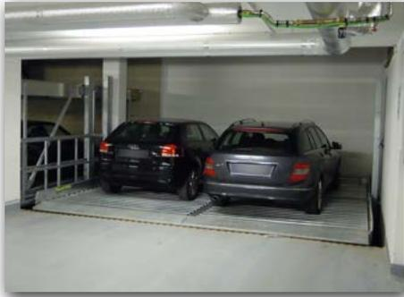
**BEKA Doppelparker zum Unabhängigen Parken** zusätzlicher Fahrzeuge mit Grube: Durch hydraulische Vertikalbewegung von Parkbühnen werden weitere Parkplätze verfügbar gemacht. Es stehen mehrere Parksystemtypen mit waagrecchten und schrägen Plattformen zur Verfügung.
