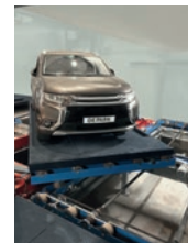
Integration einer Drehvorrichtung für ein bequemes Ausfahren ohne Rangieren (optional).
